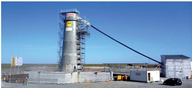
Bild 14. Foto des Prototypen der aufgelösten OWEA-Flachgründung der Ed. Züblin AG im Feldversuch nahe Cuxhaven [51]
